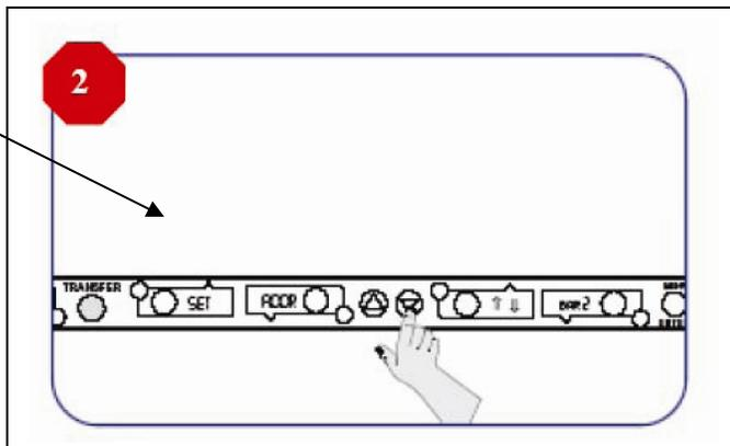
Utilice el botón de flecha arriba o abajo para desplazarse a la dirección deseada. Pulse el botón MENU / ENTER para guardar la nueva dirección y volver al modo normal de funcionamiento.
